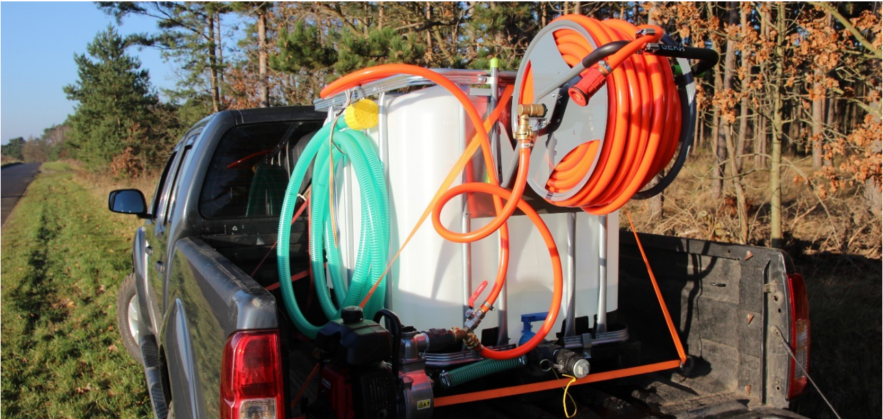
Abbildung 27: WKR Löschmodul „Forst-Feld-Farm“ auf einem Pick-up. Alle Bauteile sind im Handel kostengünstig erhältlich und einfach selbst auf ein Fahrzeug oder Anhänger zu montieren. (Fotografien: Anne Schils)
