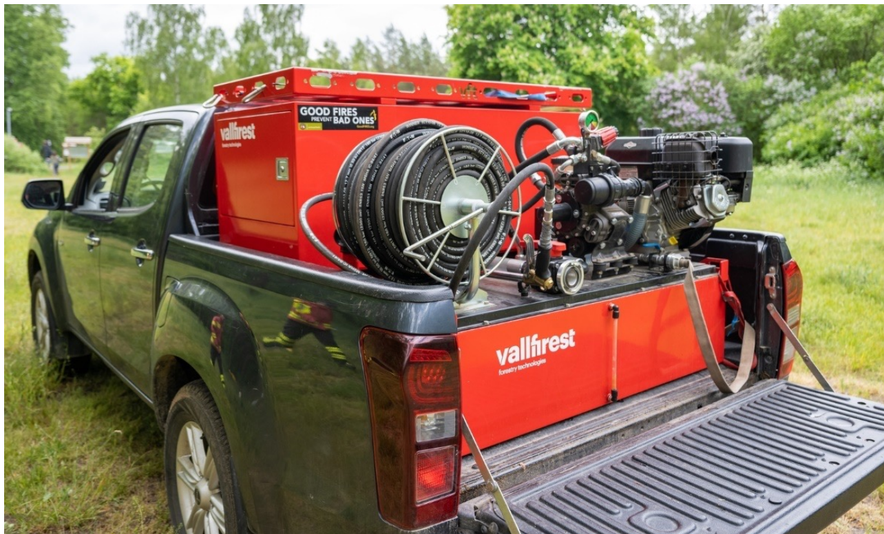
Abbildung 26: 500 Liter Wasser mit Membranpumpe. Der handelsübliche 4x4 Pick-Up ergibt zusätzlich ausgerüstet mit Feuerpatschen, Waldbrandhacken und Rucksackspritzern eine kostengünstige, multifunktionale Waldbrandeinheit.
