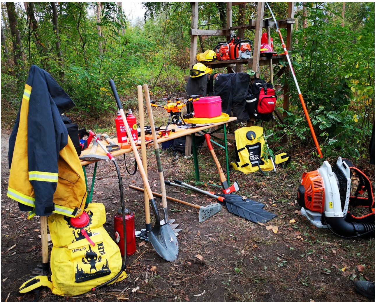
Abbildung 29: Übersicht verschiedener Geräte zur ersten Waldbrandbekämpfung (Quelle: WKR)
