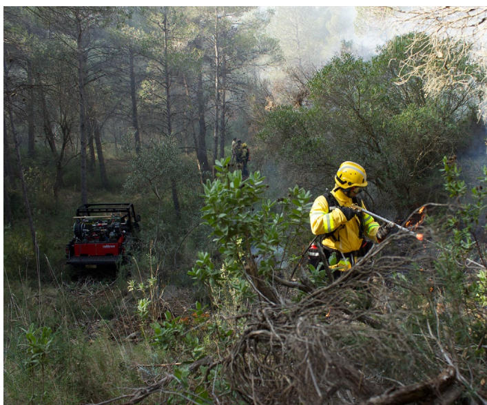
Abbildung 28: Quad mit mobilem Wassertank, Pumpe und Schlauch (Quelle: Vallfirest)
