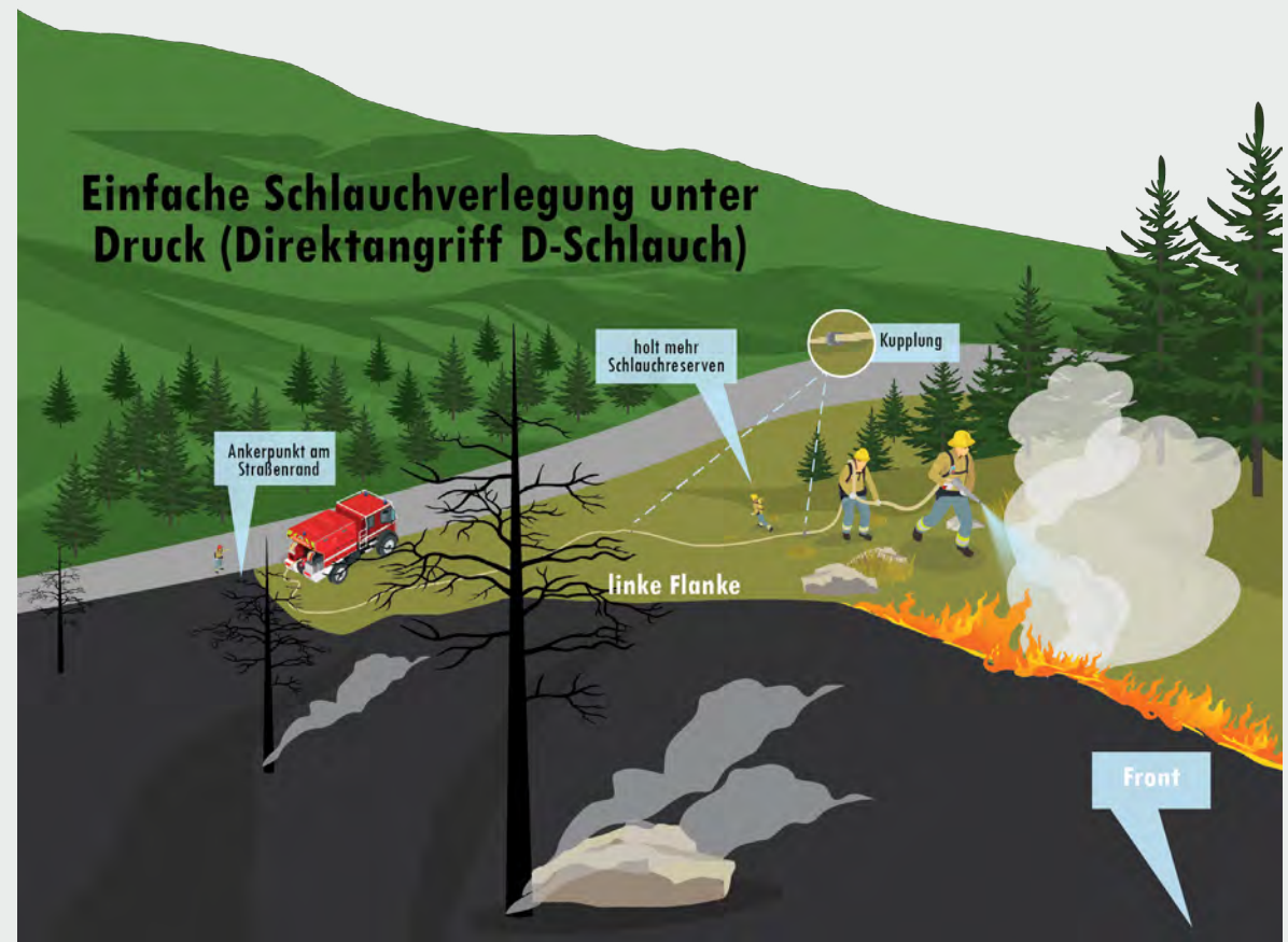
Abbildung 3.11: Einfache Schlauchverlegung unter Druck im Direktangriff
