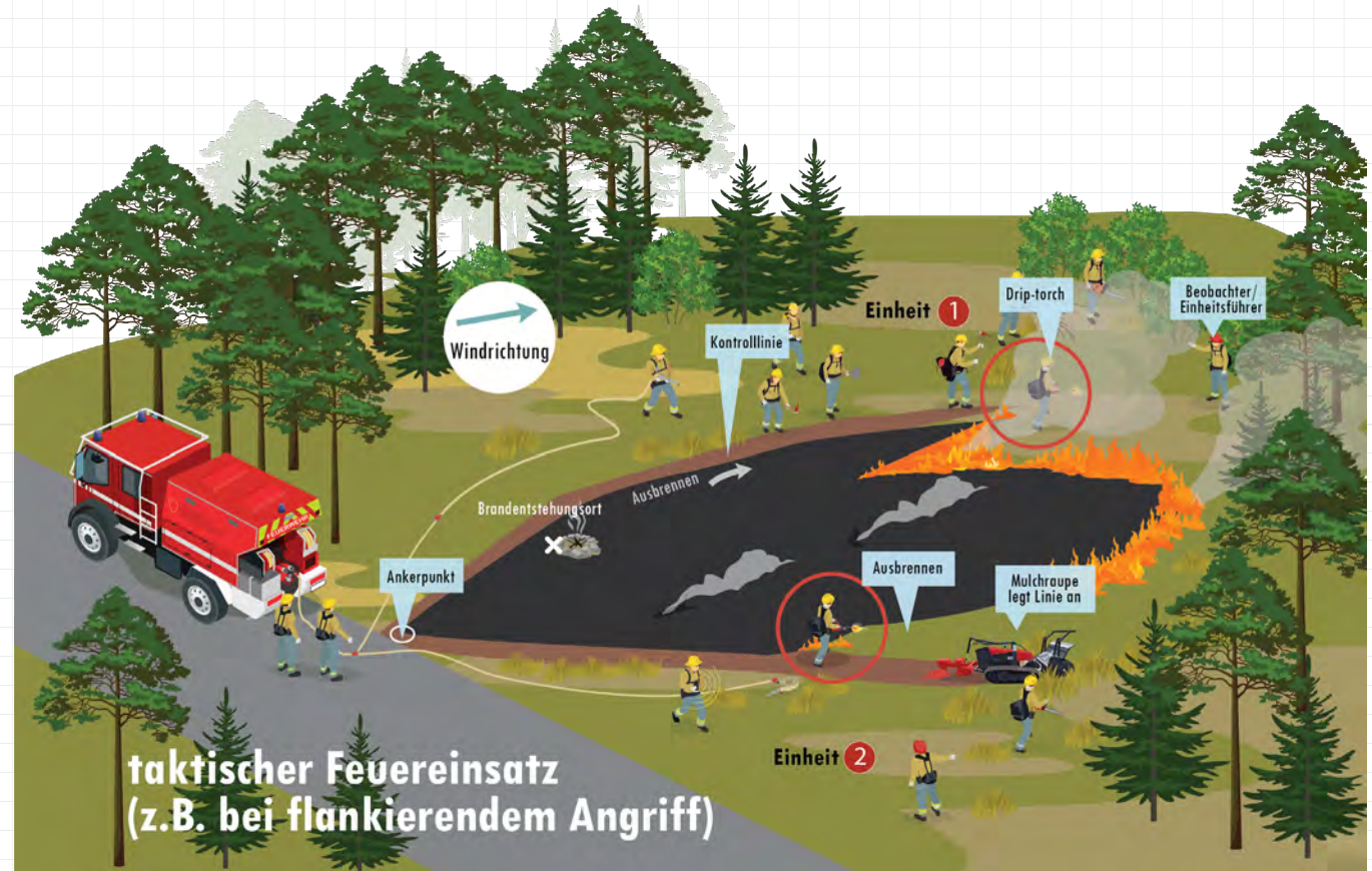
Abbildung 3.19: Beispiel "taktisches Feuer". Das Ausbrennen wird durch die Einsatzkraft mit der Drip-Torch in "Einheit 1" ausgeführt, das verbliebene Brennmaterial zwischen der Kontrolllinie / Forstweg / Strasse und dem Feuerfront wird ausgebrannt. Das Vorfeuer sollte versetzt mit der Anlage der Kontrolllinie gezündet werden, damit die Einsatzkräfte den "schwarzen" oder sicheren Bereich „mitnehmen“ können.
