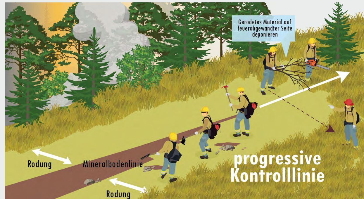
Abbildung 3.8: Progressiver Linienaufbau einer trockenen Kontrolllinie
