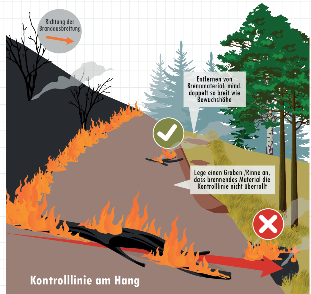
Abbildung 6. Anlegen eines Grabens/Rinne, dass brennendes Material die Kontrolllinie nicht überrollt.
