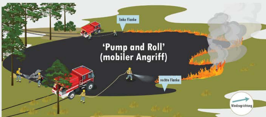
Abbildung 3.14: Fahrzeuggebundener mobiler Angriff, „Pump and Roll“. Wichtig: Im Vergleich zur Schnellangriffseinrichtung sind D-Schläuche im Notfall schneller abgekuppelt. Schlauch ggf. über Trittbretter und Spiegelhalterung hängen
