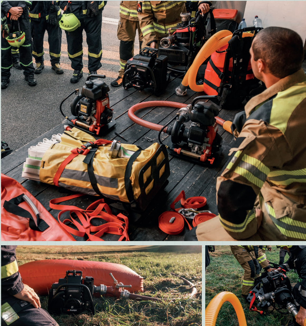
Abbildung 20: Pumpen, Schlauchmaterial und mobile Wasserbehälter per Rucksack verlastbar.
