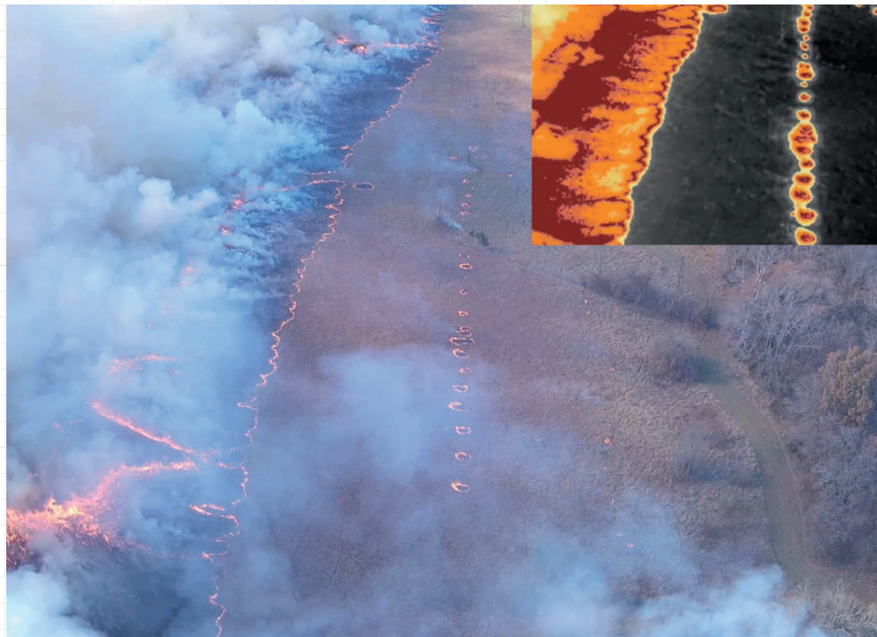
Abbildung 15 (Rechts): Die Drohnenzündung aus der Luft kann besonders in munitionsverseuchten Gebieten eine sichere und effektive Methode/Ergänzung sein, um z. B. präzise Gegenfeuer zu legen.
