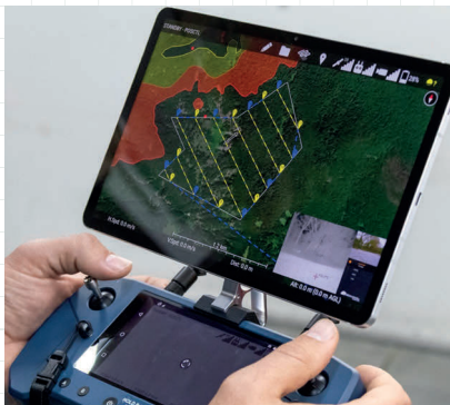
Abbildung 14 (Oben): Flugplan und -route und Zündmuster können bei der Zündung per Drohne automatisiert werden.
