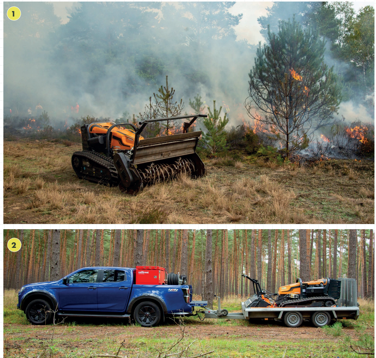
Abbildung 16: (1) ferngesteuerte Raupe mit Forstmulcher. (2) Taktische Einheit aus Pick-Up mit Schnellangriffseinrichtung und Mulchraupe.
