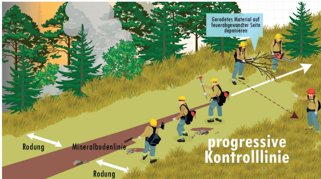
Abbildung 6 (links): Schematische Darstellung einer möglichen, sinnvollen Reihenfolge verschiedener Werkzeuge.
