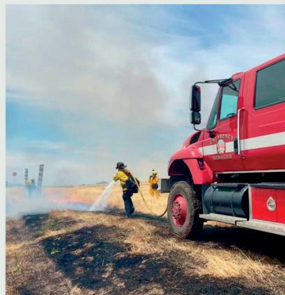
Abbildung 3.17: Beispiel von Pump and Roll / nasse Linie aus dem USA.
