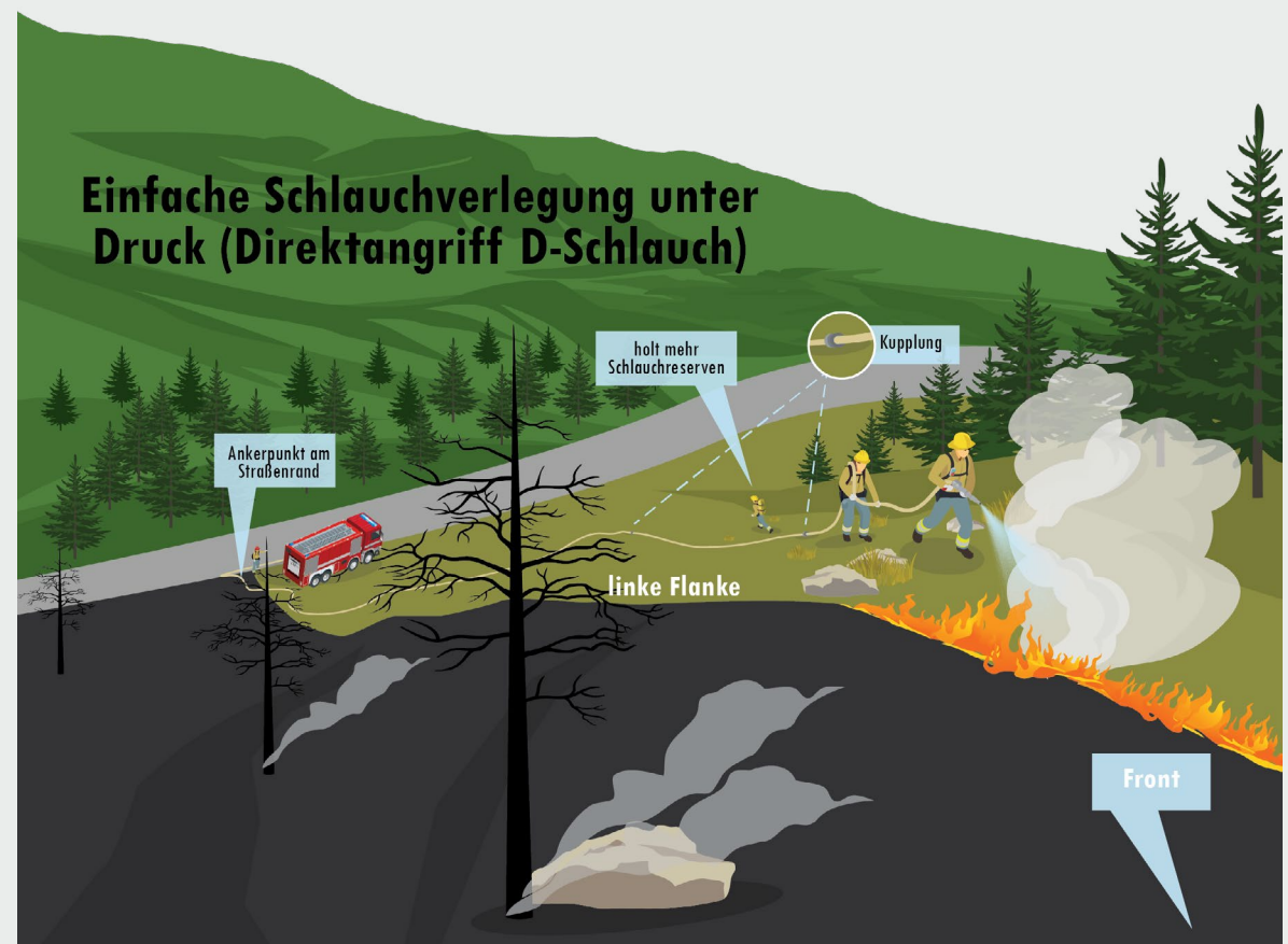
Abbildung 3.11: Einfache Schlauchverlegung unter Druck im Direktangriff
