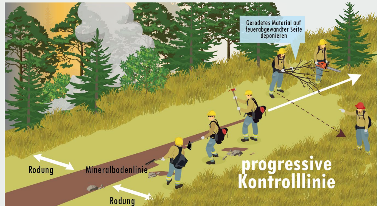
Abbildung 3.8: Progressiver Linienaufbau einer trockenen Kontrolllinie
