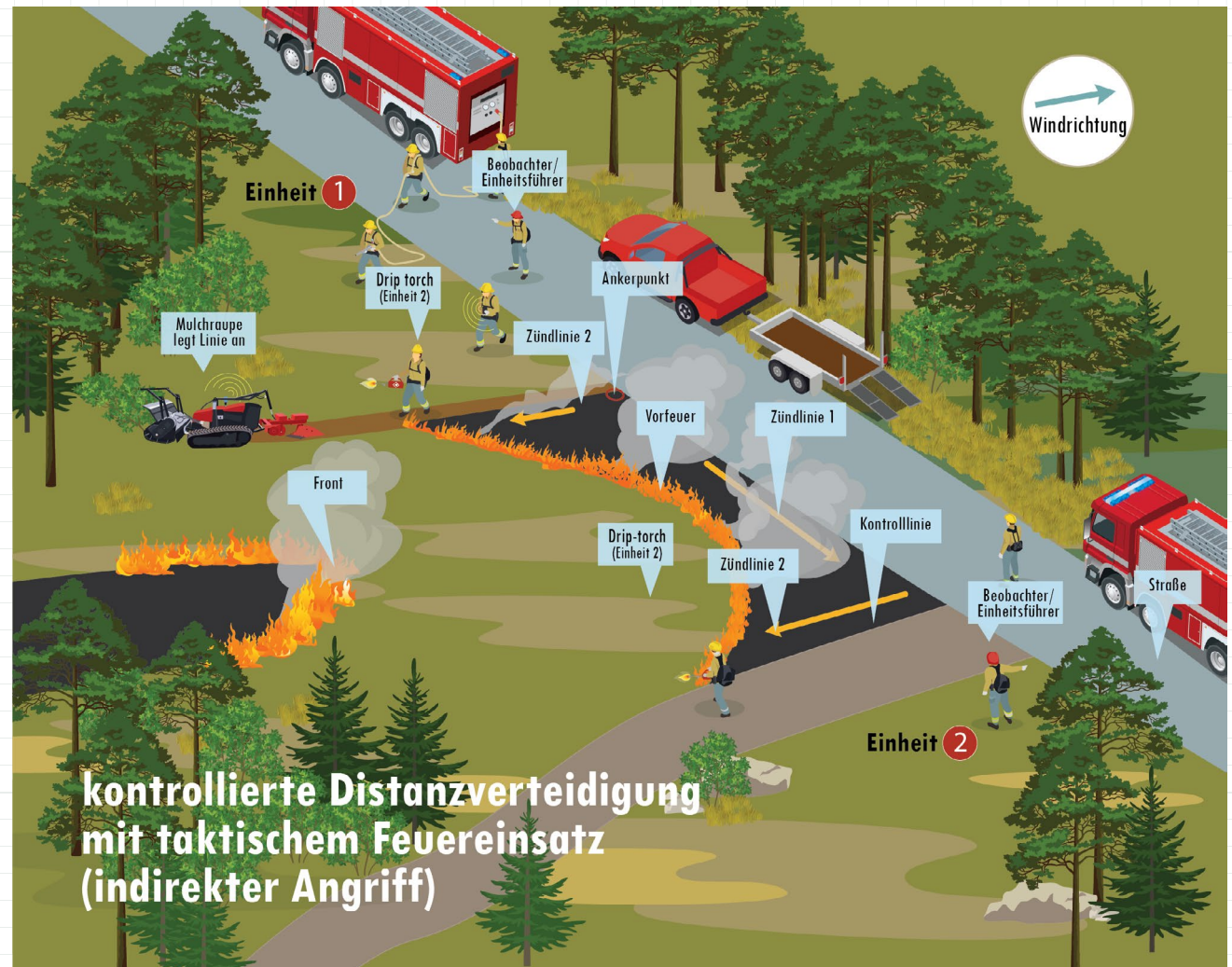
Abbildung 3.4: Verteidigung – kontrollierte Distanzverteidigung mit taktischem Feueinsatz (indirekter Angriff). Hinweis: Die Positionierung der Fahrzeuge, ob auf der Brandseite der Straße oder auf der gegenüberliegenden Seite, hängt davon ab, ob die Sicherheit der Fahrzeuge gegeben ist (d.h. kein unverbrannter Brennstoff unter und/oder um die Fahrzeuge). Sofern dies der Fall ist, positionieren Sie die Fahrzeuge auf der Brandseite, sodass der Durchgangsverkehr nicht über die Schlauchleitungen fahren kann.
